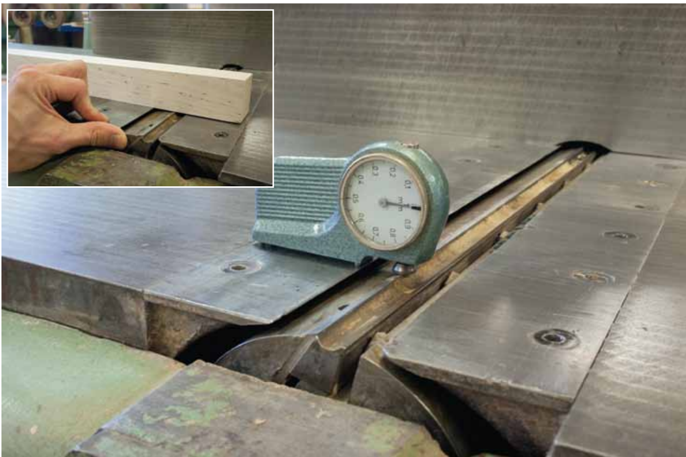
Oikohöylän takapöydän säätämisessä käytetään joko mittakelloa tai suoraa puupalikkaa.
