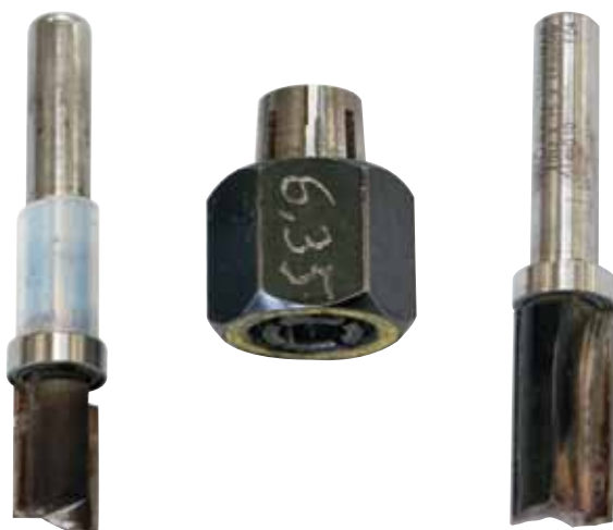
Kopiojyrsimet yläpuolisella laakerilla: 9,5 mm ja 12 mm sekä varttituumainen supistusholkki.
