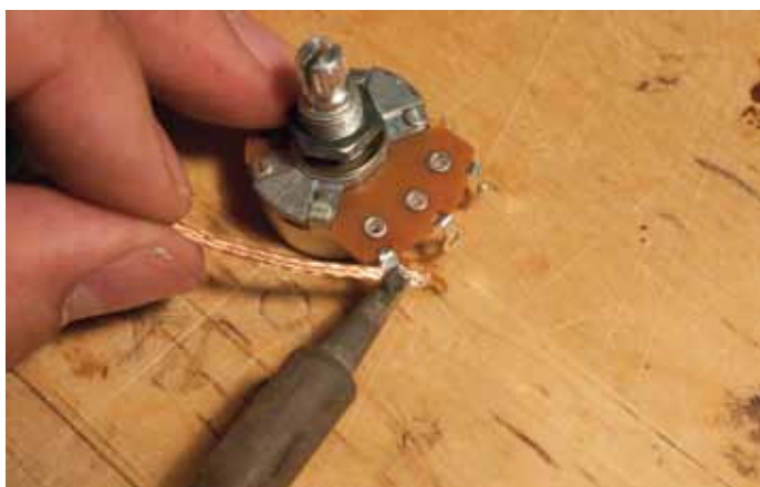
Poistettavan tinan lämmittäminen.
