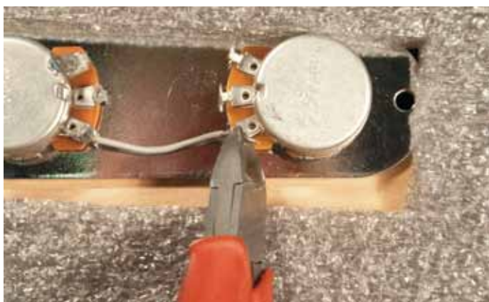
Ylimääräisten johdonpäiden katkaisu.
