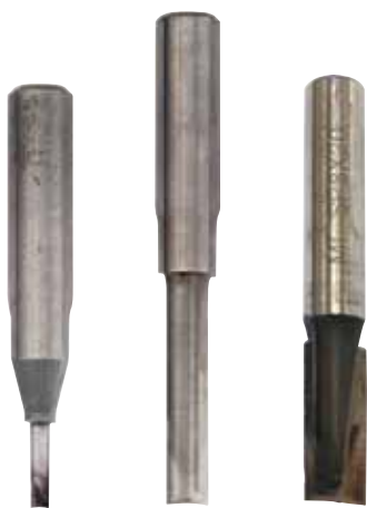
Pohjaleikkuiset urajyrsinterät: 3 mm, 6 mm ja 8 mm.
